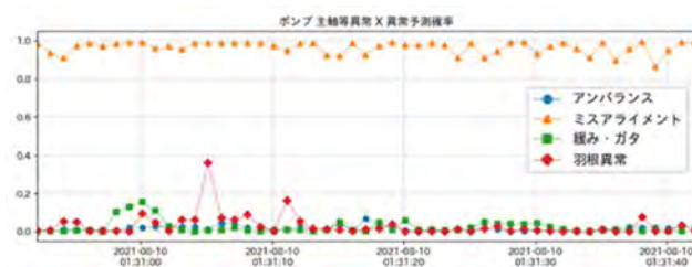
図-8 ポンプ主軸の判定結果（ミスアライメント）
