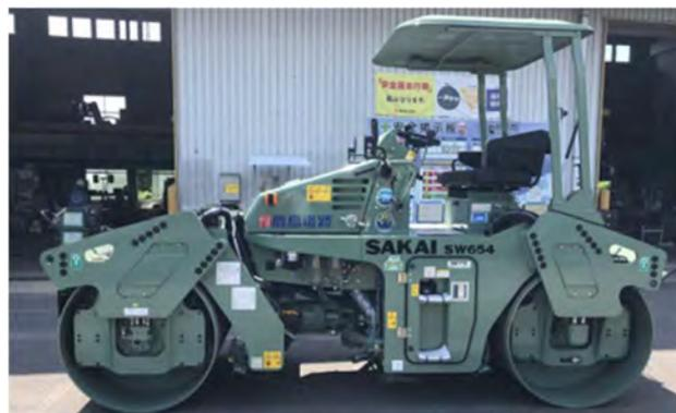
写真-1 タンデム振動ローラ SW654
