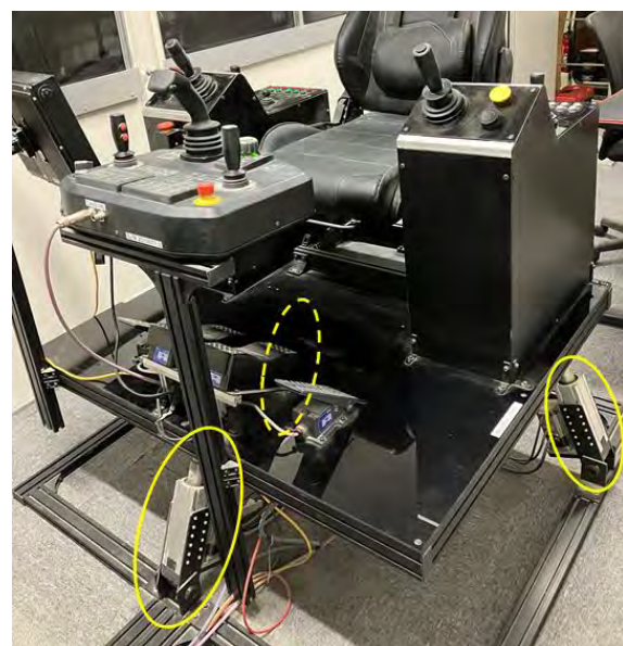
図-4 メイン操縦席下の電動式シリンダ
