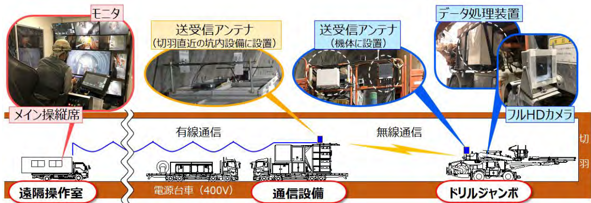
図-1 ドリルジャンボの遠隔操作システムの構成
