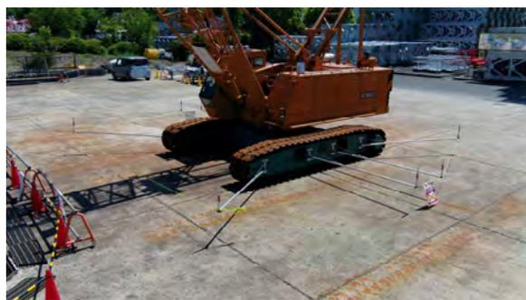
カラーコーンやA型バリケードの盛替えが不要になり、移動に伴うオペレーターの作業量が削減される事により、揚重効率の向上に貢献できると考えている。さらに、移動中においても「はさまれ・巻き込まれ・衝突」を未然に防ぐことができる。先端部には、安全ポールを取付けることにより視認性も良く、移動前に障害物の干渉を目視により確認することも可能なため、重機の衝突事故も未然に防ぐ事が可能となっている。
