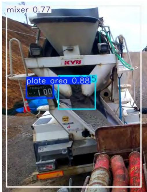
図-3 ラベル付けされた AI 検知画面
