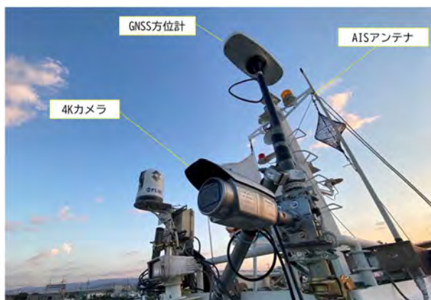
写真-2 押船への機材設置状況
