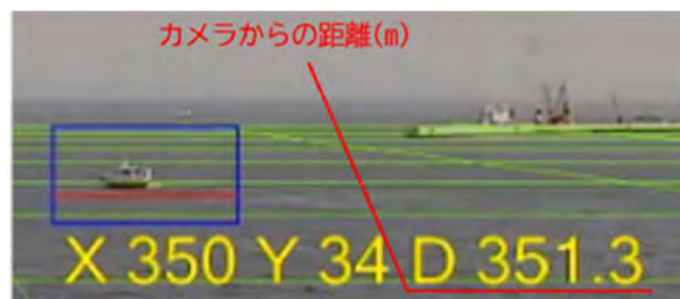
写真-3 交通船の検知状況
