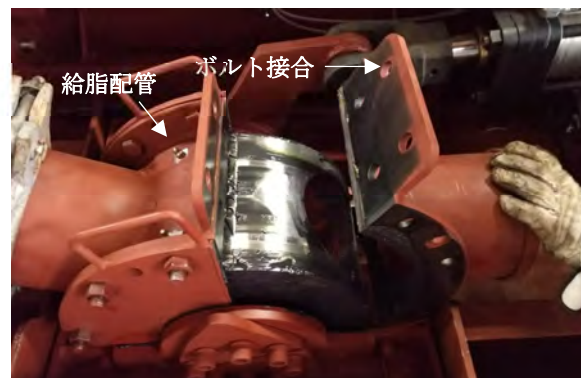
写真-5 改良版の回転式打設口
