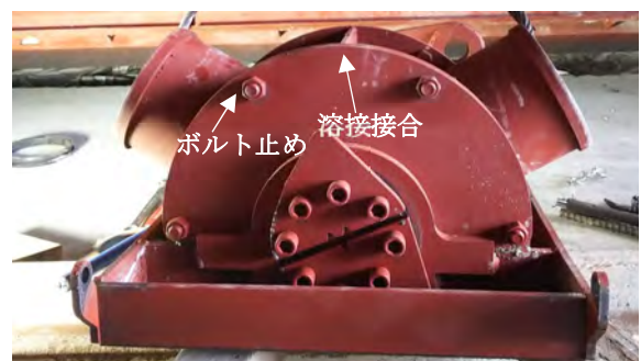
写真-4 回転式打設口の構造
