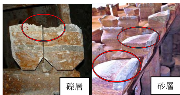
写真-1 地盤掘削後のビット例
