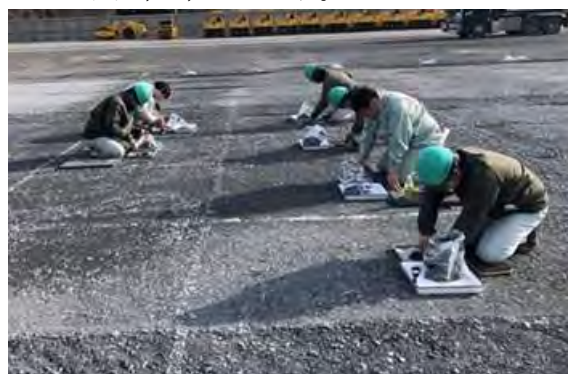
写真-3 砂置換法での密度測定
