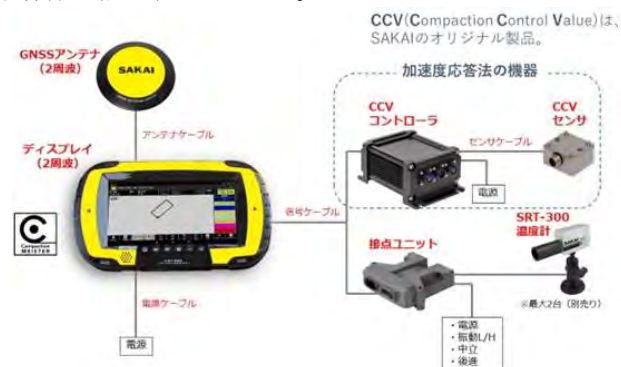
図-1 転圧管理システムの構成
