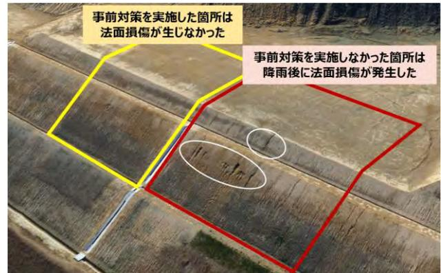
図-8 モデルエリア降雨後の法面損傷状況（4月22日地形）
