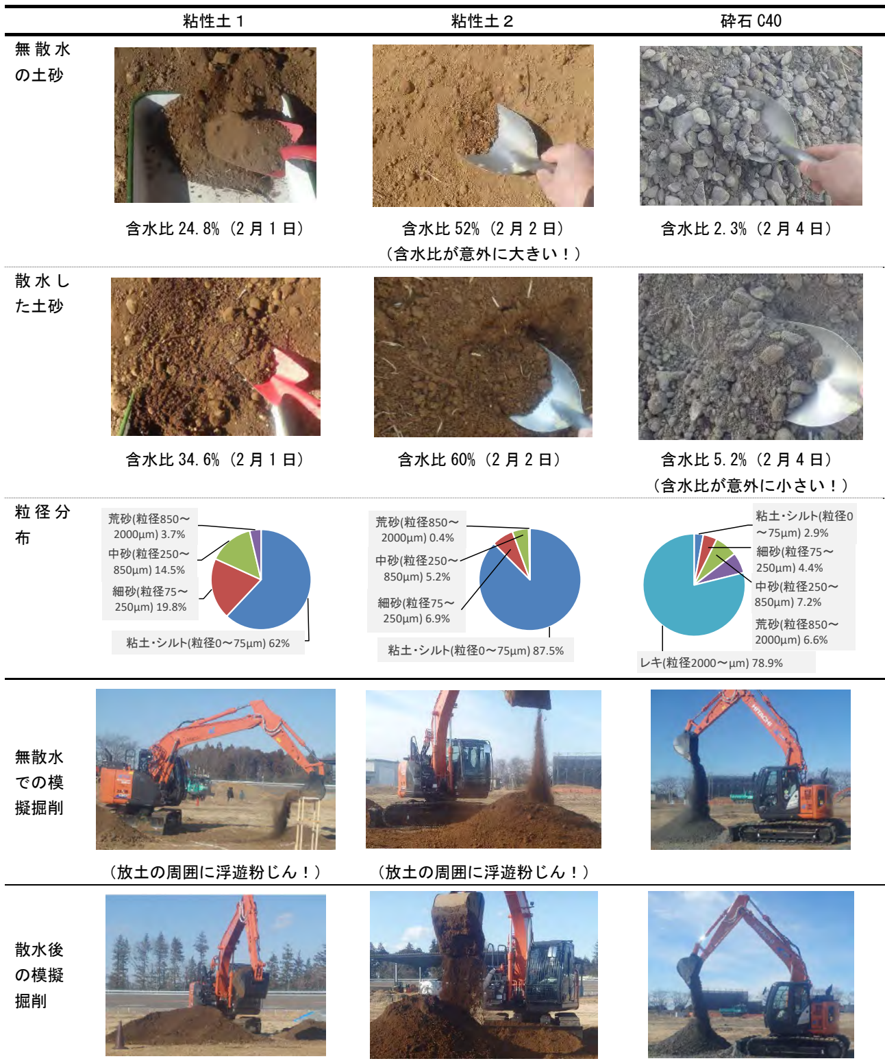
図-7 測定対象とした土砂と測定状況
