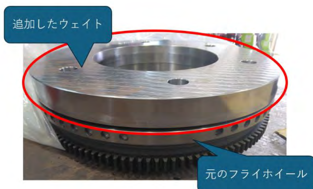
図 2-3 フライホイールウェイトの取付状態
