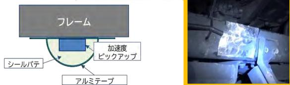
図-2 加速度ピックアップ設置状況
