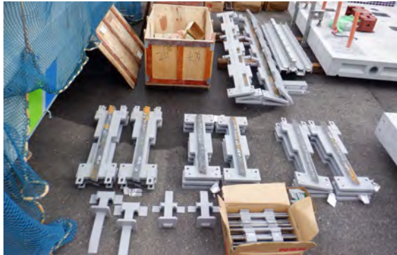
写真-4 試作した軌道部材
