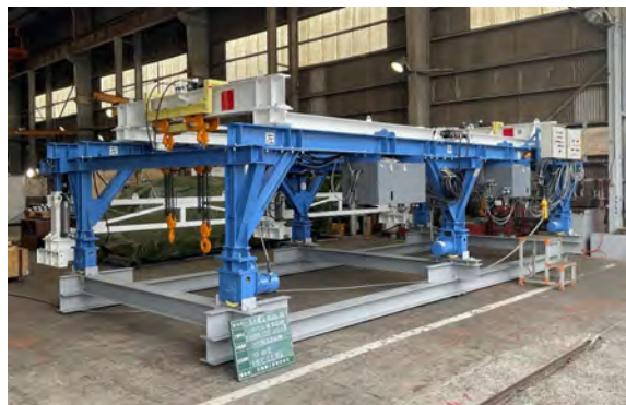
写真-5 本塗装後の床版架設機
