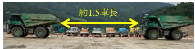
写真-5 干渉回避機能での停止状況
