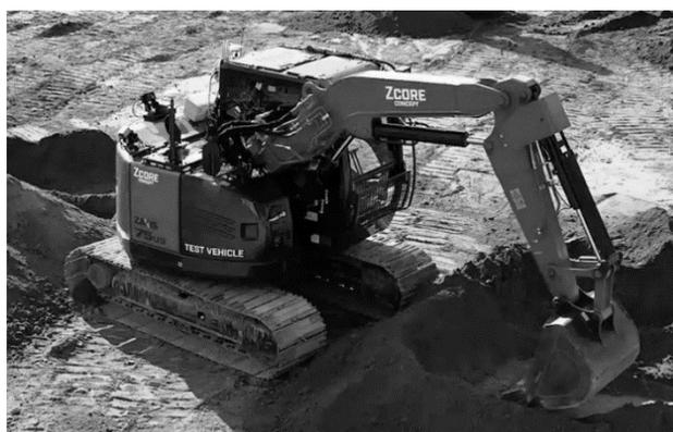
図-1 自律型油圧ショベルの外観
