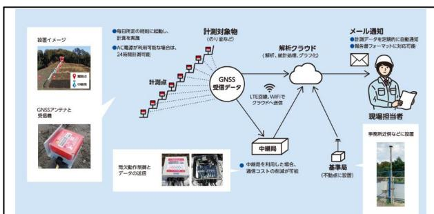
また RTK 計測アルゴリズムを用いることで上空視野が開けていないことで一般的な GNSS 技術が適応できない場所でも計測ができる（ただし上空視野が完全にさえぎられている場所では適用できない）
