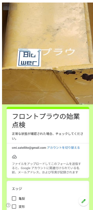
図 2 AR 点検支援ツールの動作状況 (作業装置名と点検項目の重畳表示)
