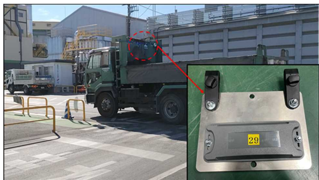
図-2 RFID タグ設置状況
