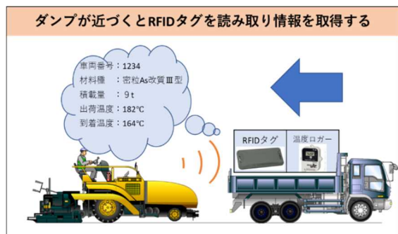
図-4 到着温度の自動取得イメージ
