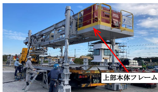
写真-9 上部本体フレーム組立状況
