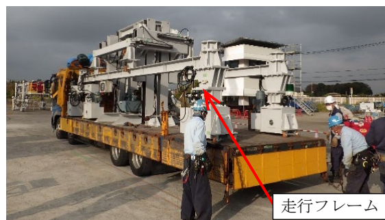
写真-8 走行フレーム組立状況
