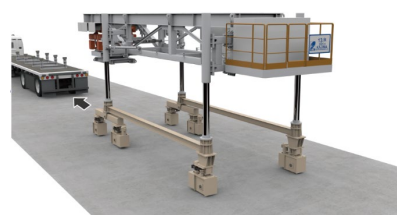
図-7 上部本体フレーム組立ステップ
