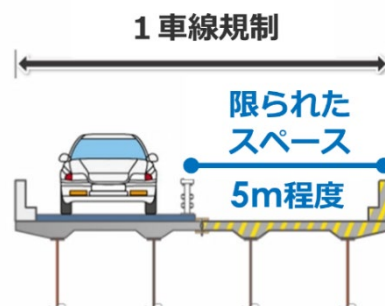
図-4 幅員方向分割取替工事の施工条件
