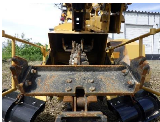
写真-2 掘削刃（幅 610 mm）
