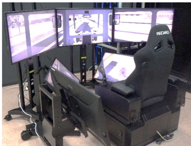
写真-3 開発した除雪グレーダ操作シミュレータ
