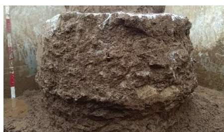
写真-4 掘削した改良体（側面）
