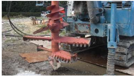
写真-2 攪拌装置全景
