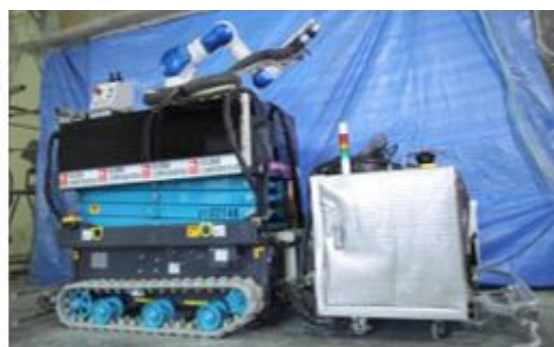
写真-1 耐火被覆吹付ロボット(2020年)
