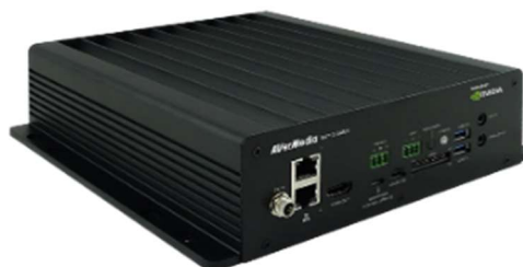
写真-3 周囲認識コントローラ
