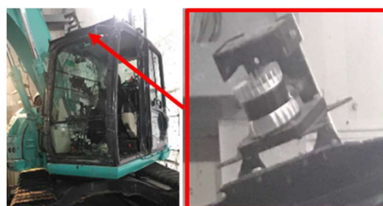
写真-4 搭載した LiDAR
