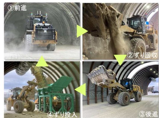
図-1 ホイールローダによるずり出しの一連動作
