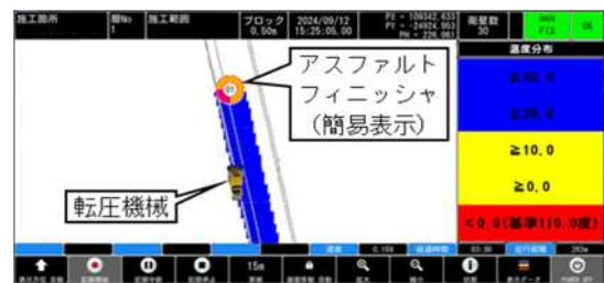
図－8 転圧機械のモニタ画面
