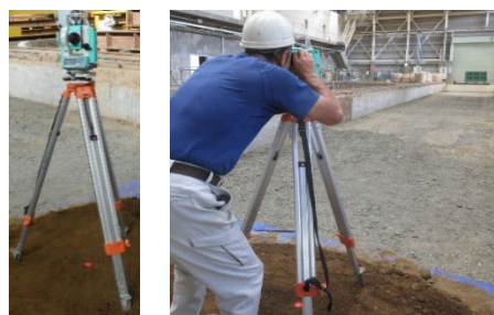
写真-1 従来の TS を用いた観測状況
