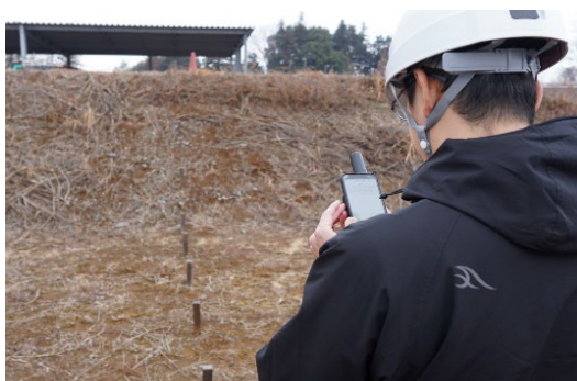
写真-3 スマートフォン内蔵カメラによる計測状況
