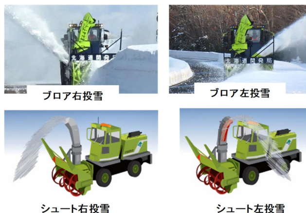
図-9 ロータリ除雪車の作業装置自動化
