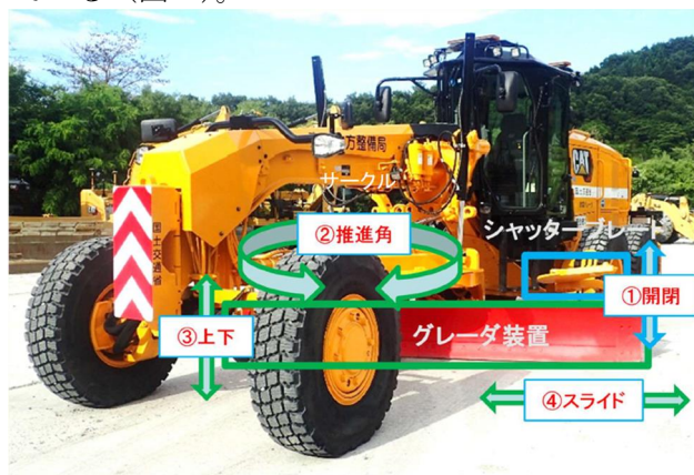
図-7 除雪グレーダの作業装置自動化
