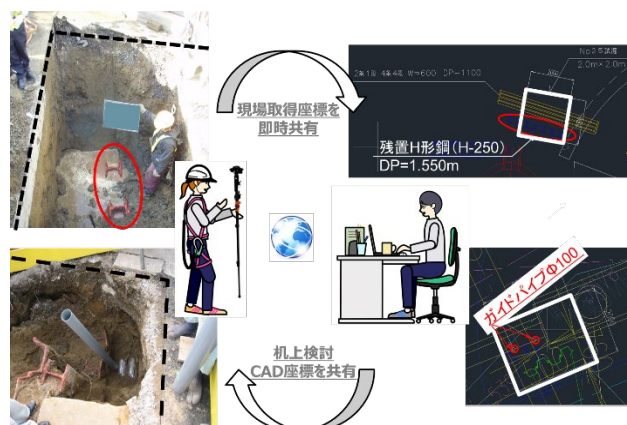
図-7 埋設管試掘後の測位結果共有例
