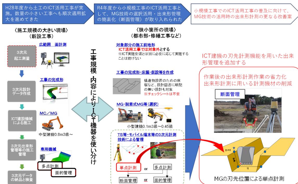
図-1 マシンガイダンスの刃先計測機能を用いた出来形管理手法 (イメージ)
