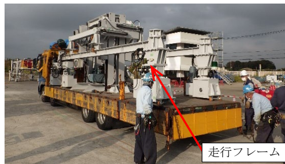
写真-8 走行フレーム組立状況
