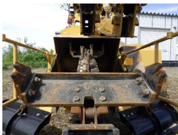
写真-2 掘削刃（幅 610 mm）
