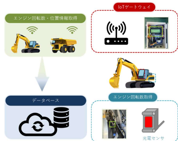
図-1 『N-ECOMS(ネコムズ)』システム構成
