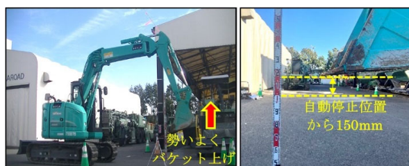
写真-5 検証試験2「バケット上げ検証」
