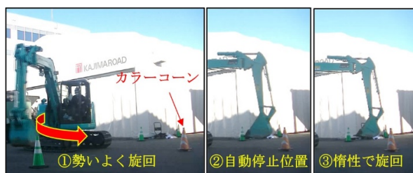
写真-6 検証試験3「旋回検証」
