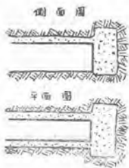
○湧水は少いが集塊岩、砂質等の如きもので注入圧力に耐え得ないような地質の場合 10~20 米と相当距離導坑を疊築する場合
