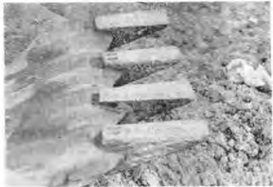
写真 1 神鋼製 HF-11 熔接棒でハードフェーシングを施した 15 K ショベル掬器の爪
