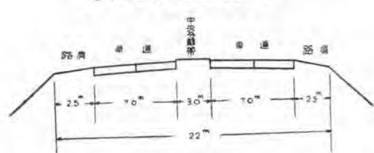
高速自動車専用道路標準断面図
