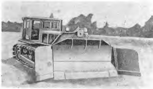
図-4 拡幅具付ブルドーザ デー 275 型
