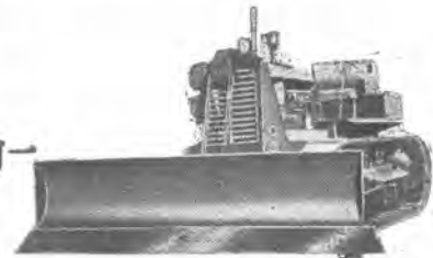
10屯アンクルドーザー
