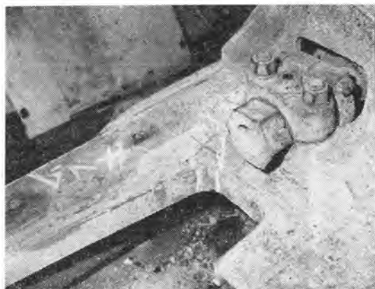
Fig. 2 フレーム亀裂(定期整備の車には左右いずれも発生している)
