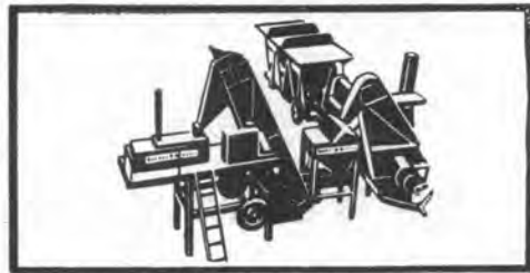
INTERMEDIATE HOT MIXES. ミキサー及び ドライヤーを併用して毎時45屯以上を 生産できます
