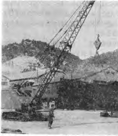
第4図 HD4型ユニバーサル エキスカバータ (某造船所における鋼材運搬)
