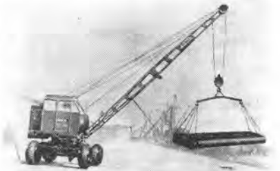
写真-4 小型モビールクレーン
