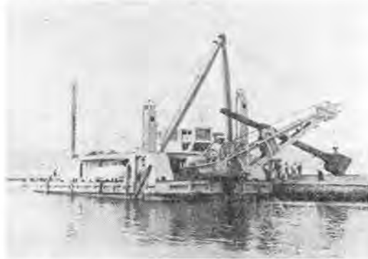
写真-1 ディーゼルエレクトリック・ディッパー 浚渫船「はこだて号」
