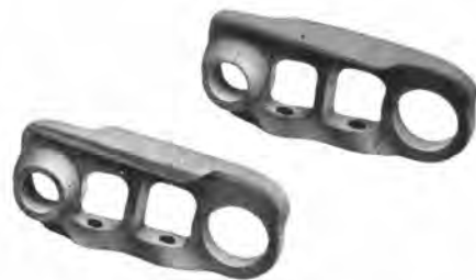
写真1) D-8リンクの修理前修理後を示すものです
