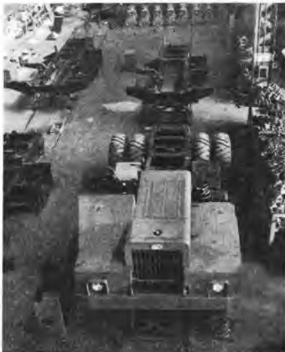
写真-2 GZ型ダンプシャーシ組立完了
