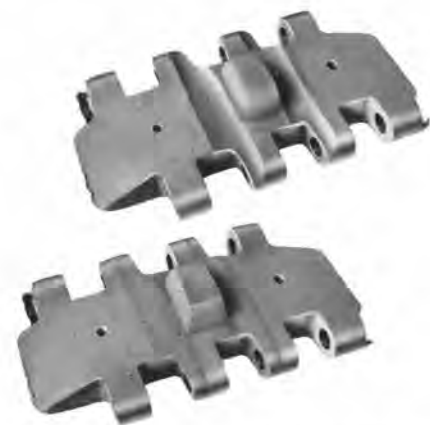
写真3) クレーンクローラーパッドの修理前修理後を示すもので、トレッド面、ローラー当り面、駆動爪等の摩耗部分に肉盛、構造強度的補強を施す完全再生
