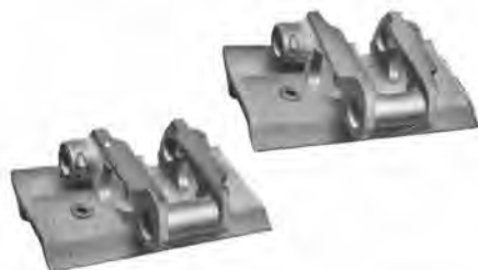
写真2) 小松型リンクの修理前、修理後を示すものです。プレートのラグ、リンク、ブッシュの当り面等の摩耗部分に肉盛、オーバーサイズピン使用に依る完全再生修理
