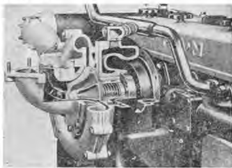
写真-8 MAN 自動車用エンジン装着排気タービン (送風機翼車は軸流形式)
