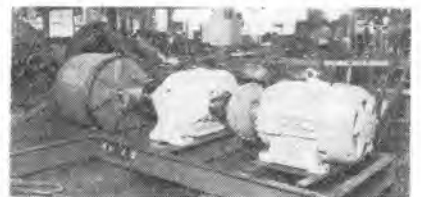
写真-6 17.5 HEM 型、佐久間ダムベルトコンベヤモータ 75HP × 1,200 rpm
