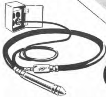
ワンマンバイバー (特許) (電気式棒状バイブレーター)
