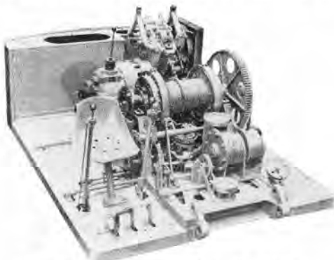
写真-2 2本レバー操作 O & K L151a 型
