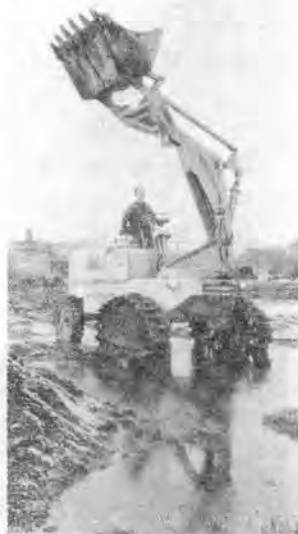
写真-10 Ahlmann A 111 Z ホイルローダ、後輪をクローラにかえたもの
