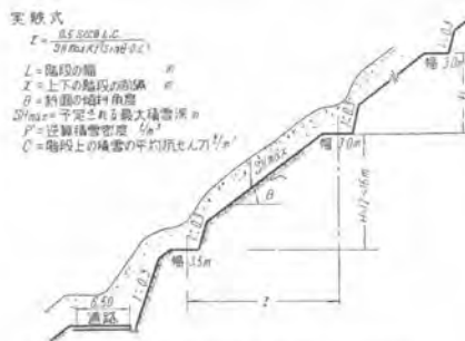
図-11 雪崩止め階段工標準図
