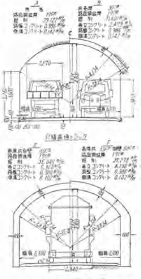
図-8 奥只見新設道路折立一八崎線工事ずい道
