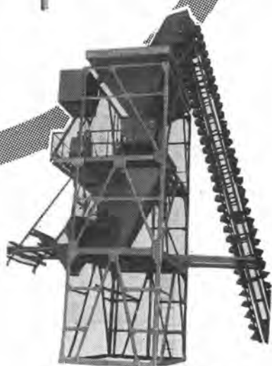
バッチャープラント
