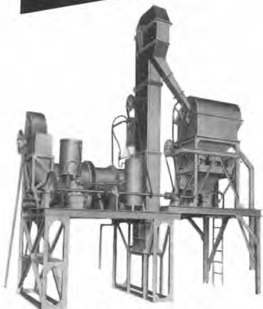
アスファルトプラント
